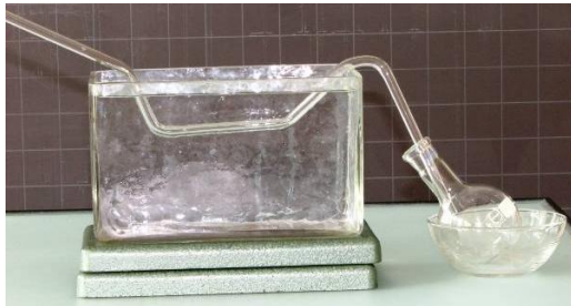
Kühlrohr mit Kühlbecken und Vorlage
