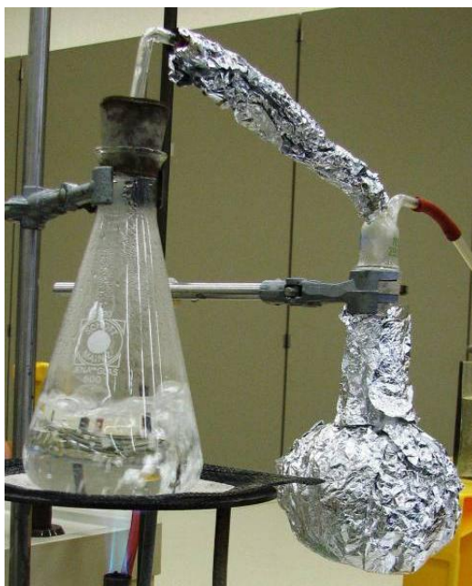
Dampferzeuger in Betrieb
