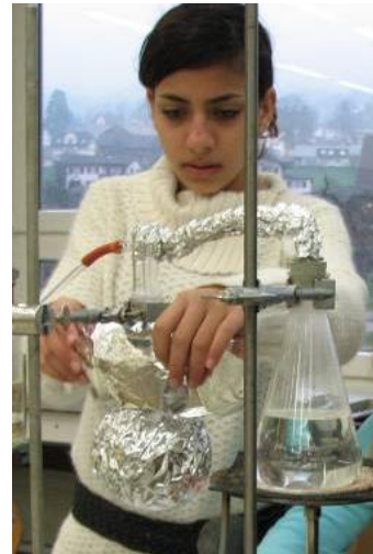
Isolieren der Anlage
