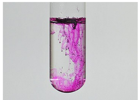
Holzasche wird in Wasser mit Phenolphthalein-Lösung gegeben.
